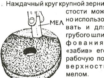
Наждачный круг крупной зернистости можно использовать и для грубого шлифования, «забив» его рабочую поверхность мелом.
