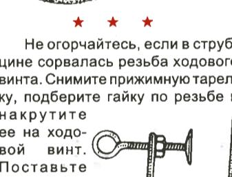
Не огорчайтесь, если в струбцине сорвалась резьба ходового винта. Снимите прижимную тарелку, подберите гайку по резьбе и накрутите ее на ходовой винт. Поставьте тарелку на место и расклепайте конец винта. Струбцина будет работать отлично.
