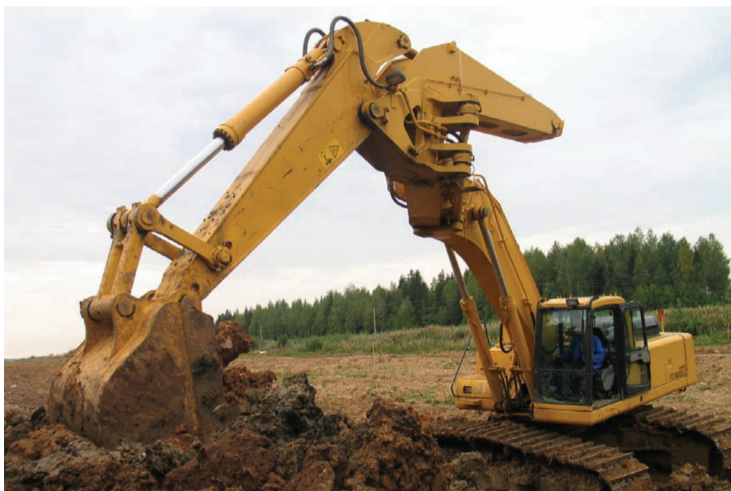
Экскаватор «Komatsu» с изменяемой геометрией стрелы
