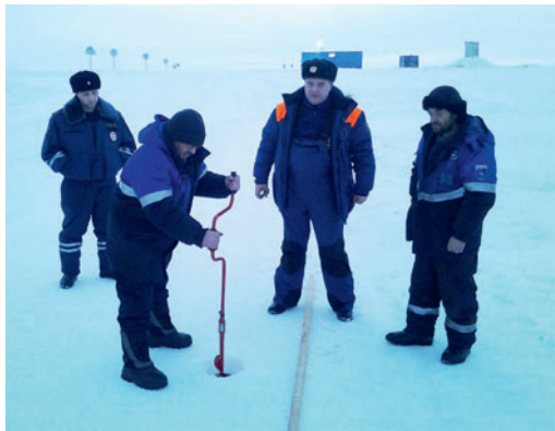
Проверка состояния полотна дороги
