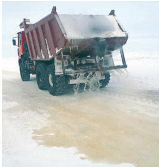
Проливка полотна автозимника
