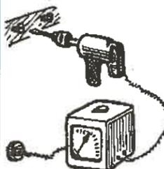
дрель вклучить через автотрансформатор, то, регулируя напряжение, можно изменять число оборотов и крутящий момент электродреели.
