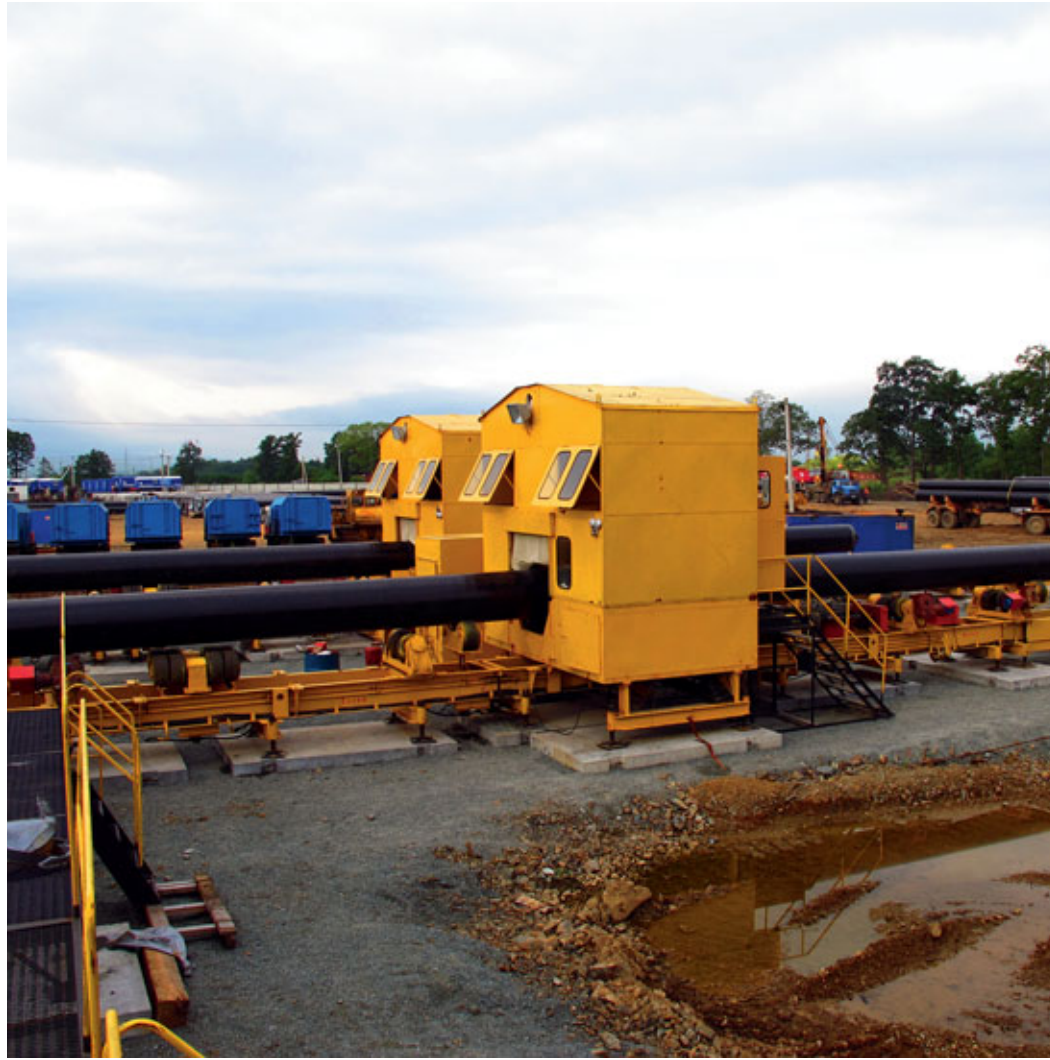
Трубо сварочный комплекс ТСК-142
