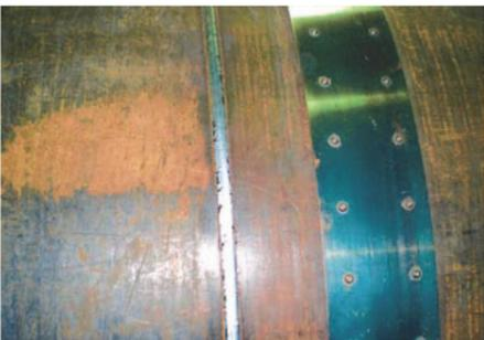
Внешний вид шва, сваренного автоматической сваркой на трубе 1420 мм
