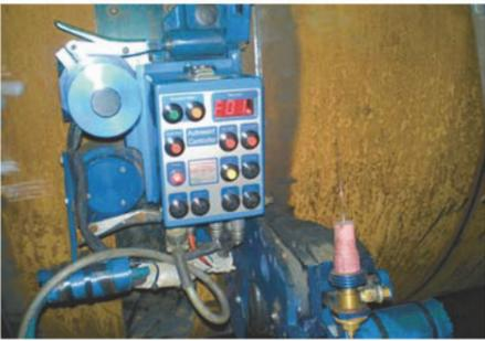
Общий вид сварочной головки Аутовэлд
